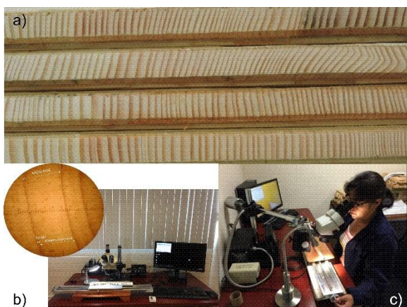
Figura 2. a) Muestra los anillos de crecimiento posterior al proceso de pulido, b y c) indican el sistema de medición Velmex y la forma en que se realiza la medición del ancho de los crecimientos anuales.
