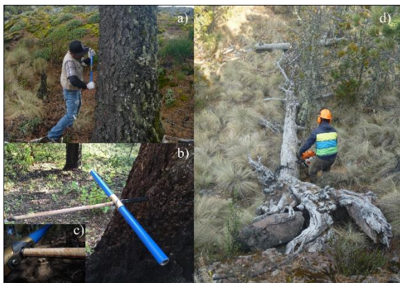
Figura 1. a) Indica la toma de muestras (virutas) de árboles vivos empleando taladro de Pressler de diferentes diámetros (5 y 12 mm) y longitudes, esto último para alcanzar el centro del árbol, b y c) extracción de la muestra y d) obtención de secciones transversales de árboles muertos con el apoyo de una motosierra.
